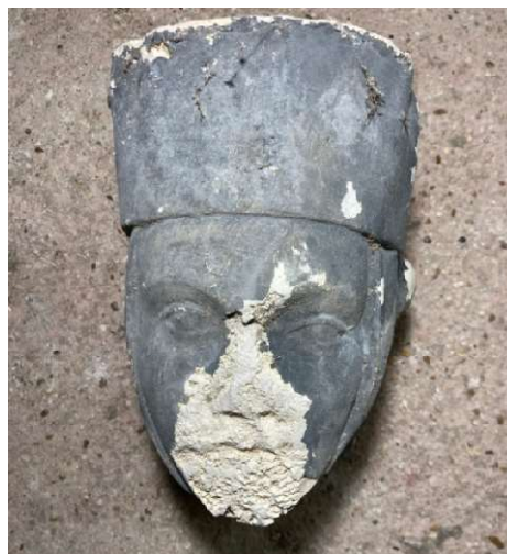
M16 b – De l'eau a perlé sur ce moulage entraînant la dissolution d'une partie du visage.
