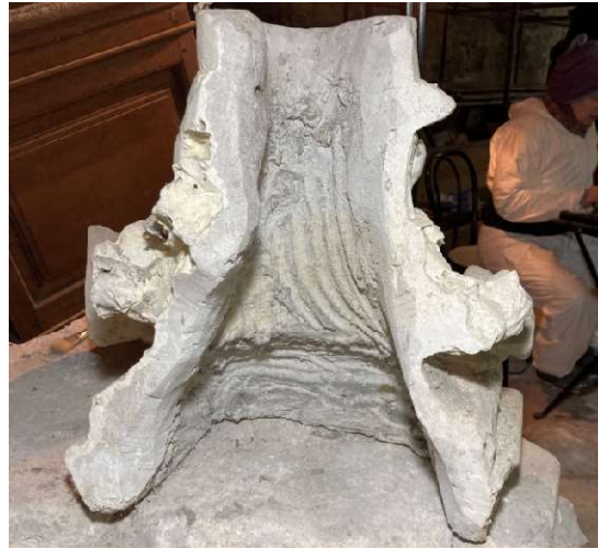
M13 – Absence de filasse ou autre matériau organique visible.
