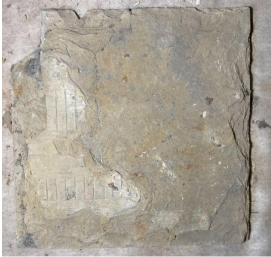
LAP.2023.62 - La surface originale a quasiment disparu par délitage
