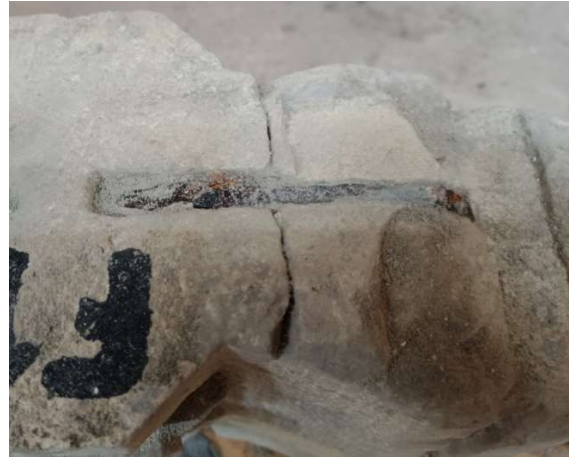
F16 – Agrafe métallique maintenant un fragment.
