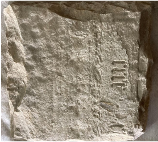
LAP.2023.65 - Surface très altérée, avec desquamations locales.
