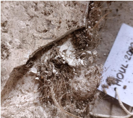
MOUL.2023.063 – Filasse dépassant de la 2 e couche de plâtre.
