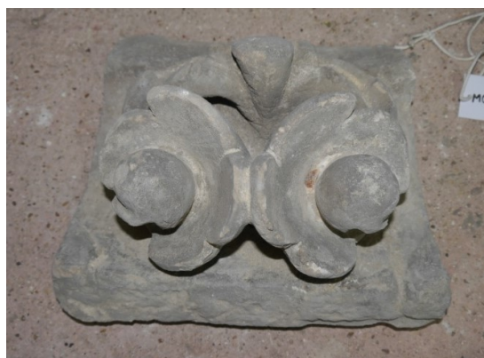
MOUL.2023.034 - Coloration très sombre et uniforme prise par la surface encrassée (crypte du Vieux-Chapitre).
