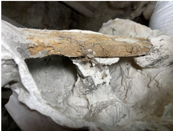
M4 a et b – Pourriture et vermoulures constatées.
