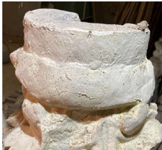
Petites marques en relief caractéristiques de l'emploi d'un moule estampé en terre.
